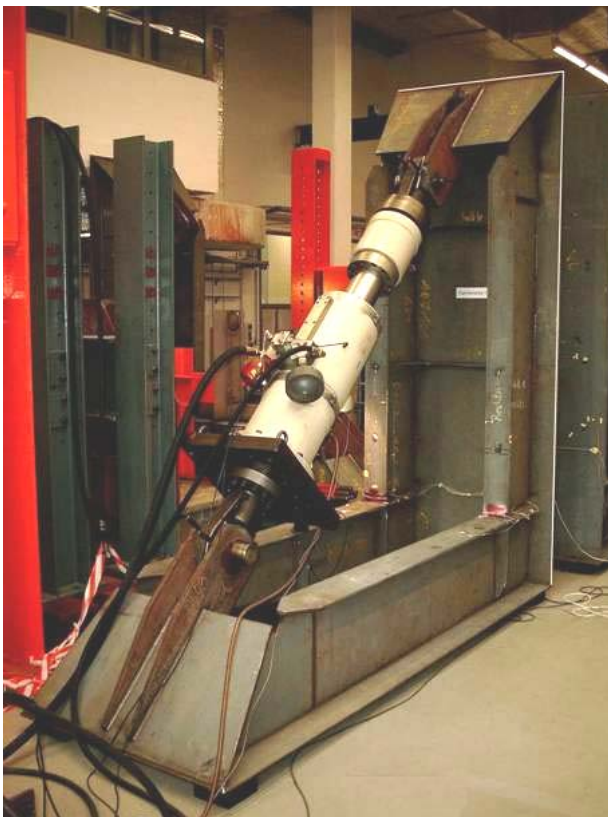
Abb. 2.5: Versuchsaufbau und anrisskritische Nahtübergänge bzw. Hot-Spots HS1 - HS6
