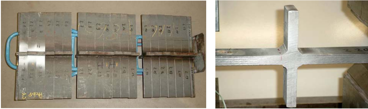
Abb. 3.2: Herstellung und Prüfung der Detailproben "Kreuzstoß"
