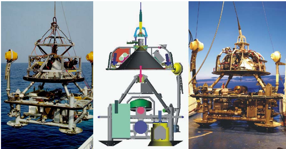
Abb. 4: Der MODUS Prototyp für Flachwasser (Version GEO1), MODUS für Tiefwasser im CAD-Schnittbild sowie als Prototyp (beide Version GEO2), alle mit Bodenstationen
