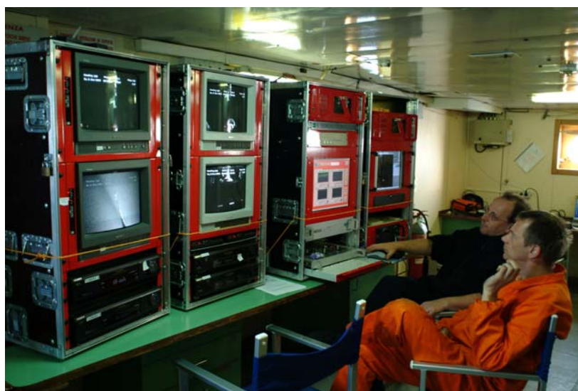
Abb. 23: Leitstand zur Steuerung und zum Messdatenmanagement an Bord des Einsatzschiffes
