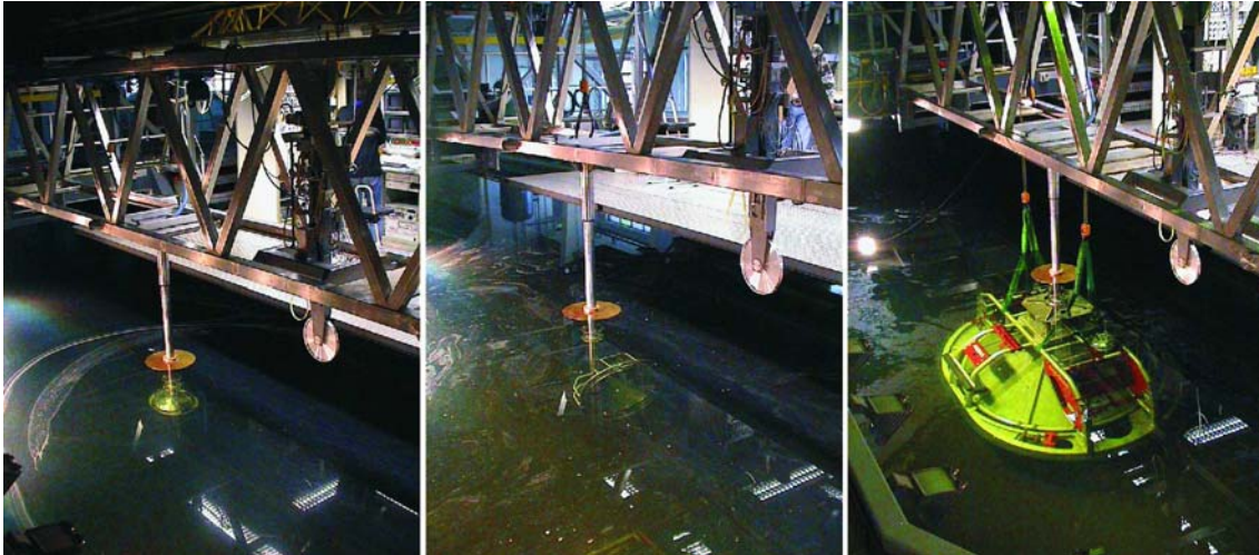
Abb. 19: Widerstandsversuche in der Tiefwasserrinne der ZE VWS der TU Berlin von links nach rechts: Modelle von MODUS in M 1:5, M 1:3 (hier für Vertikalfahrt hochkant montiert) und der Prototyp
