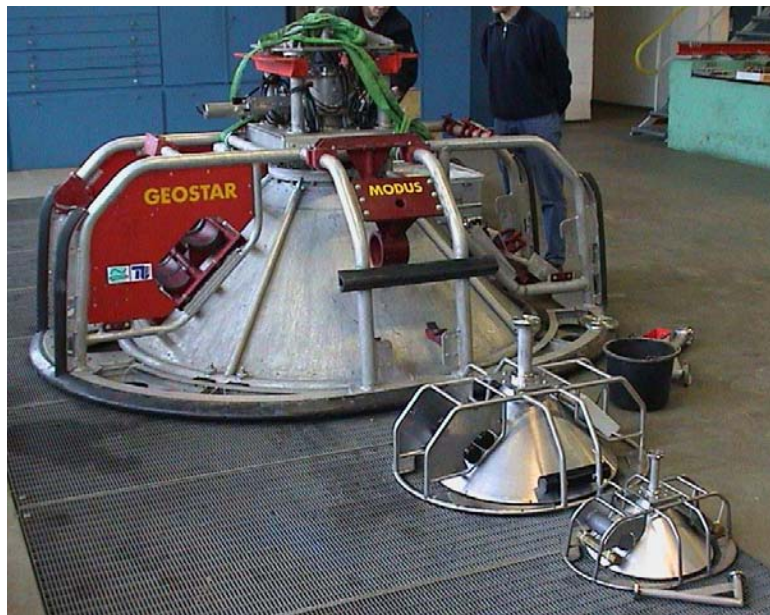
Abb. 18: Prototyp und Modelle von MODUS (GEO2) im Maßstab 1:3 und 1:5
