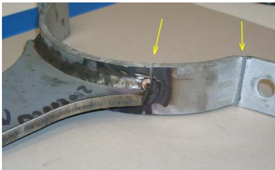
Abb. 4.29 Anriss vom Nahtübergang zur Rohrschelle mit anschließendem Schellenbruch rechts (Variante 5)
