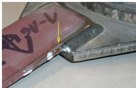
Abb. 4.32: Anriss an der überlappten Schweißverbindung (Variante 3)
