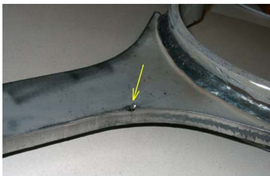
Abb. 4.31 Anriss an der ausgerundeten Blechkante (Fehlstelle bei Variante 5)
